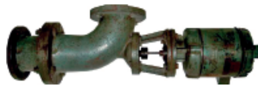
İlk ısıtma suyu sirkülasyon pompası, 1929 model, HP tipi DN 67/0.25 kW "dirsekli pompa"
